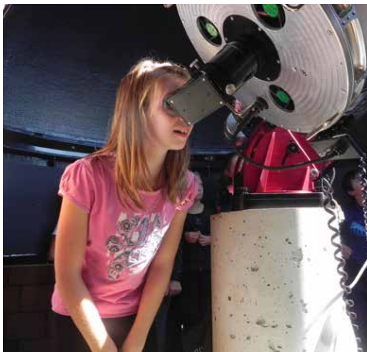
L'observatoire est équipé d'un télescope de type Ritchey-chrétien, d'un miroir de 317 mm et d'une monture équatoriale Paramount. Une caméra (CCD pour les initiés) permet de prendre des clichés de haute qualité.
